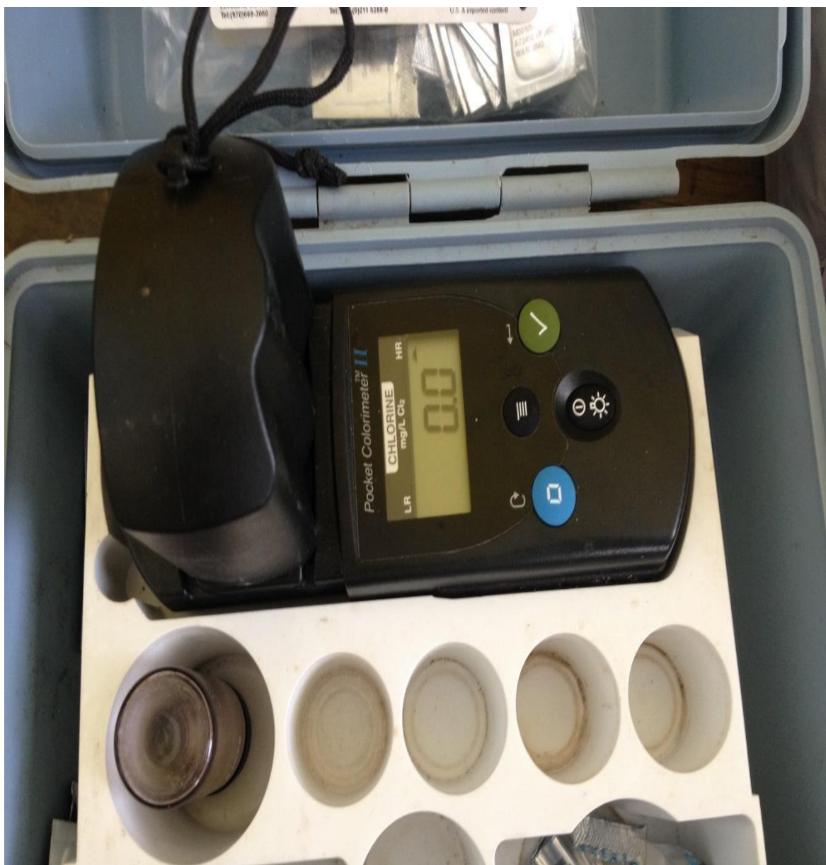
Figura 12: Medición del cloro residual in situ con equipo CLORIMETRO POCKET II.
