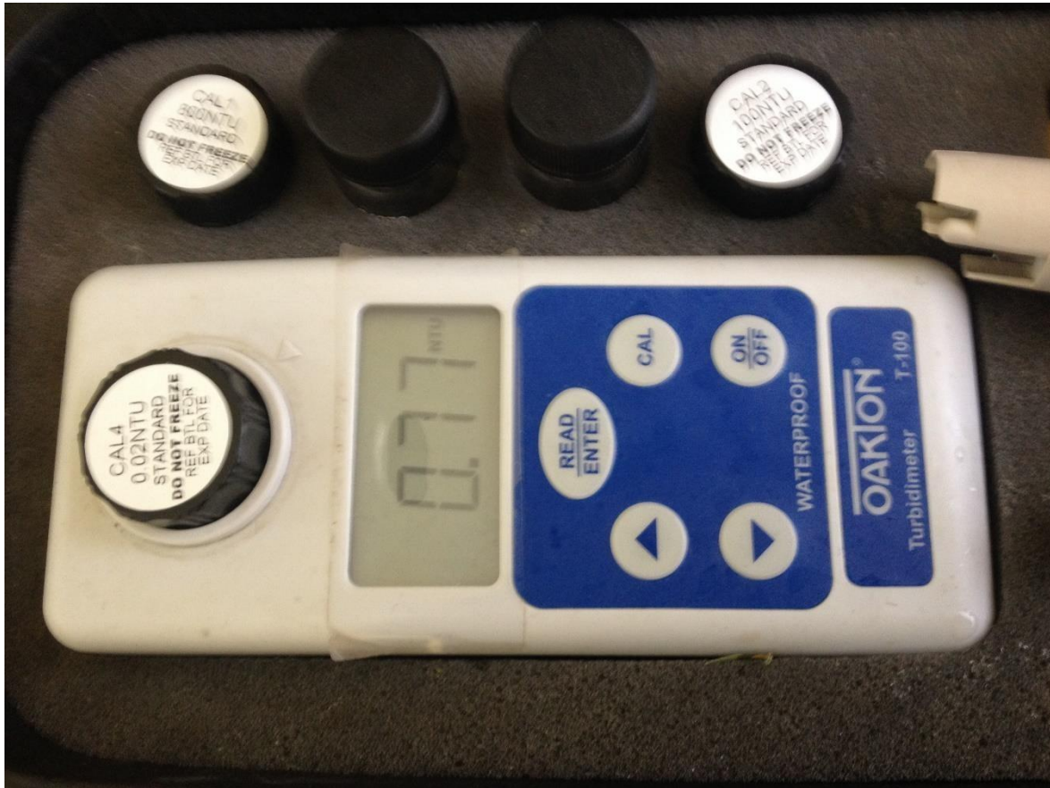
Figura 15: Medición de la turbidez con equipo Turbidímetro portátil en laboratorio..
